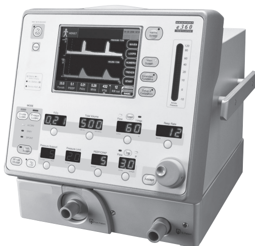
Рис. 1-1. Аппарат ИВЛ Newport e360
